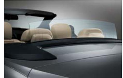
■ **Glasheckscheibe**, elektrisch versenk- und beheizbar: Die Scheibe lässt sich unabhängig vom Verdeck vertikal absenken und hochfahren. Bei geschlossenem Verdeck und abgesenkter Scheibe wird der Innenraum für ein angenehmes Klima wirkungsvoll be- und entlüftet. Bei geöffnetem Verdeck verbessert die hochgefahrte Heckscheibe den Komfort auf den hinteren Plätzen.
