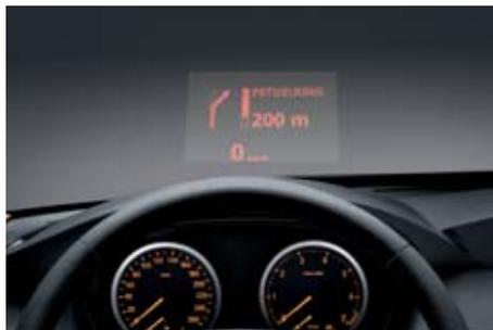
□ **Head-Up Display** liefert dem Fahrer direkt ins Blickfeld fahrrelevante Informationen, beispielsweise über die aktuelle Geschwindigkeit. Darüber hinaus lassen sich Pfeilhinweise der Navigation, Funktionen der Aktiven Geschwindigkeitsregelung und Check Control darstellen.
