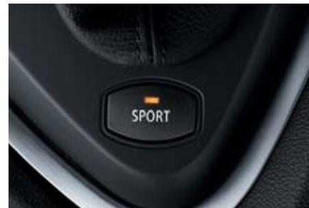
■ **Fahrdynamik Control (Sportmodus)**, per Tastendruck spricht der Motor noch spontaner auf die Betätigung des Gaspedals an. Beim Automatikgetriebe wird ins Sportprogramm gewechselt, bei SMG werden die Schaltzeiten verkürzt. Zusätzlich wird die Lenkkraftunterstützung für eine bessere Rückmeldung von der Straße reduziert, und die Geschwindigkeitsregelung beschleunigt stärker.
