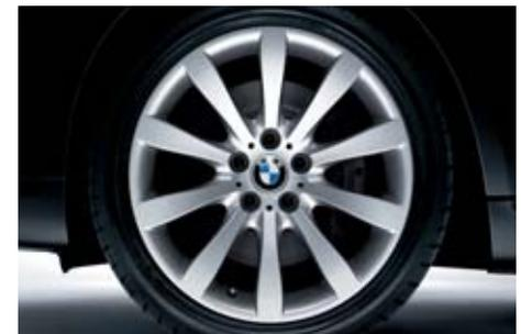
□ **Sternspeiche 218** mit Notlaufeigenschaften und Mischbereifung, vorn 8,5 J x 19 Zoll, Bereifung 245/40 R 19, hinten 9 J x 19 Zoll, Bereifung 275/35 R 19.
