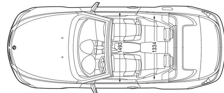
Alle Maßangaben der technischen Zeichnungen in Millimeter. Gepäckraumvolumen beim BMW 6er Cabrio ca. 300 Liter (mit hochgeklapptem Verdeckkasten 350 Liter, VDA-Messung), Gepäckraumvolumen beim BMW 6er Coupé ca. 450 Liter (VDA-Messung).
