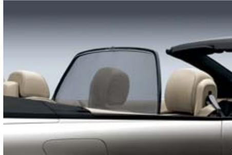
□ **Windschutz** ermöglicht genussvolles Offenfahren ohne Zugluft und störende Verwirbelungen im Schulter- und Nackenbereich; der Windschutz lässt sich einfach bedienen und kann platzsparend im Gepäckraum verstaut werden.
