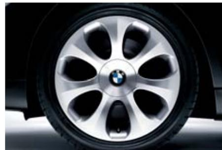
□ **Ellipsoidstyling 121** mit Notlaufeigenschaften und Mischbereifung, vorn 8,5 J x 19 Zoll, Bereifung 245/40 R 19, hinten 9 J x 19 Zoll, Bereifung 275/35 R 19.
