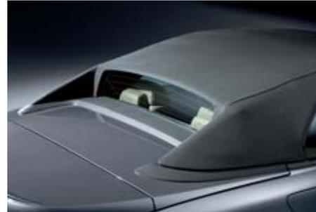
■ **Finnen-Verdeck**, vollautomatisch. Setzt Maßstäbe in der Akustik und bei der Dämmung von Witterungseinflüssen. In Verbindung mit der absenkbaren Heckscheibe bietet es eine wirkungsvolle Belüftung des Innenraumes. Geschlossen verleiht es dem Cabrio eine coupéhafte Silhouette und findet nach dem Öffnen Platz in dem im Gepäckraum untergebrachten Verdeckkasten. Erhältlich in Grau und Schwarz.
