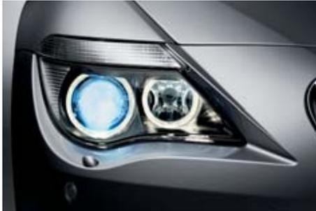
■ **Xenon-Licht für Ablend- und Fernlichtfunktion**, inkl. automatischer Leuchtweitenregulierung, leuchtet die Fahrbahn nachts, bei schlechter Witterung oder Sicht, deutlich besser aus. In Kombination mit dem optionalen **Adaptiven Kurvenlicht** werden Kurven durch eine elektromechanische Steuerung der beweglichen Scheinwerfer ausgeleuchtet, sobald der Fahrer in sie einlenkt.
