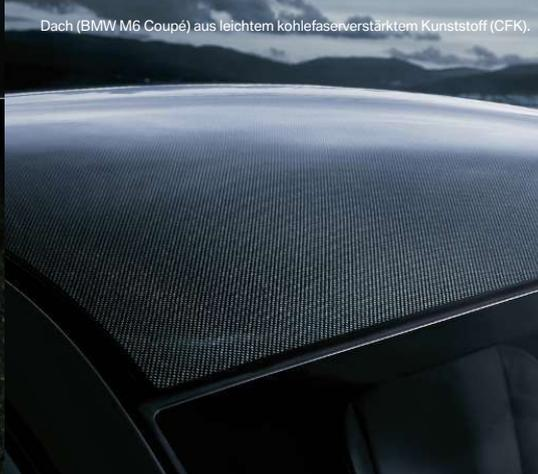
Dach (BMW M6 Coupé) aus leichtem kohlefaserverstärktem Kunststoff (CFK).
